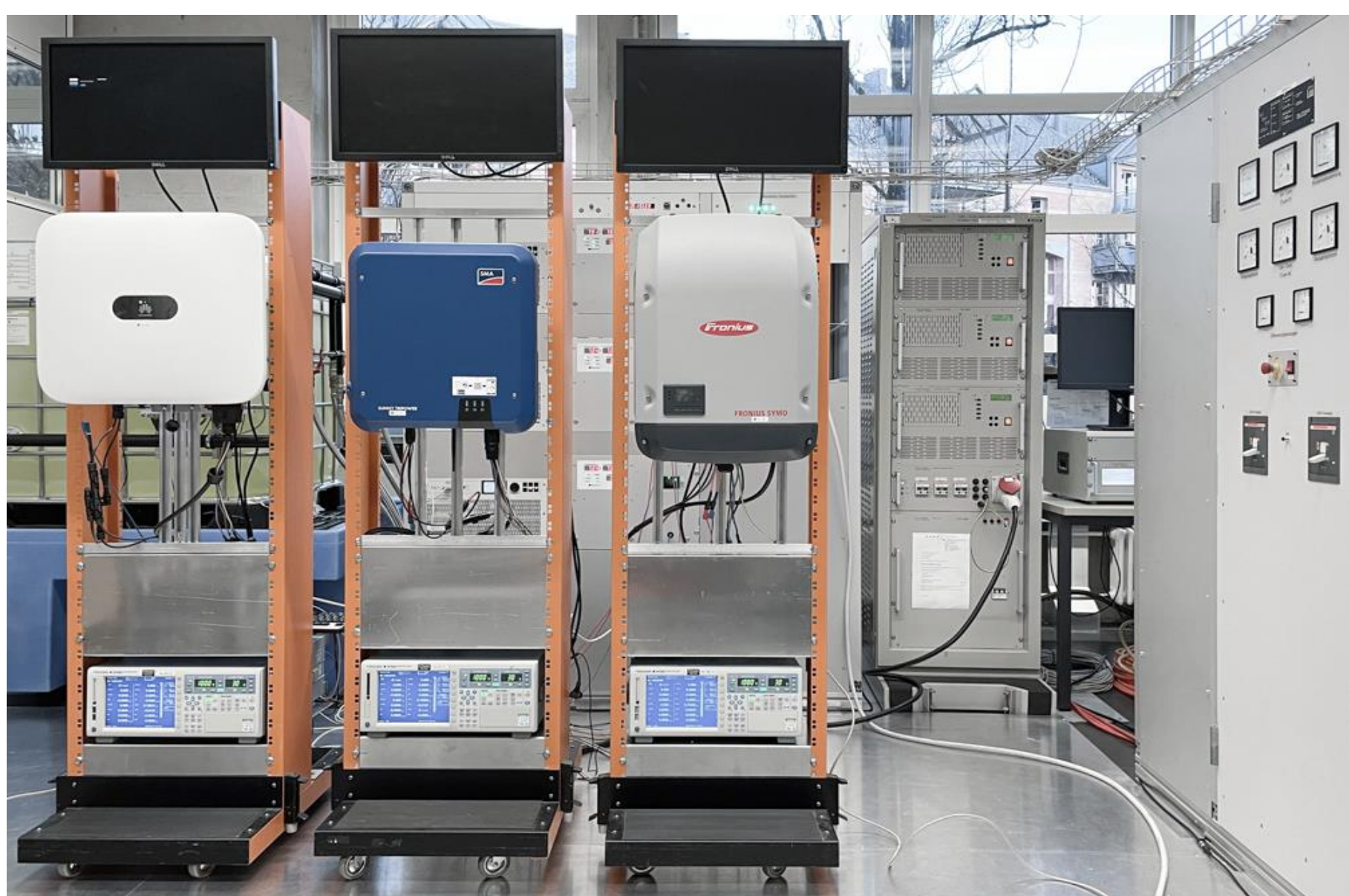
Abb. 1: Untersuchte Wechselrichter (vorne) mit den variablen DC- und AC-Simulatoren (hinten) im Labor der BFH
